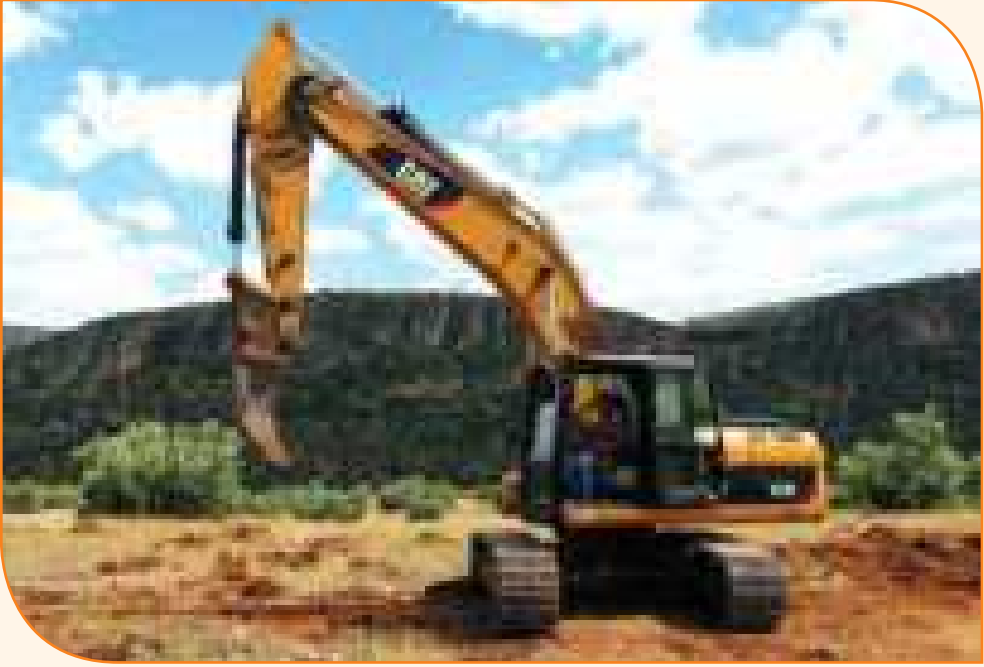
Resim 3.28: Tek Riper Ekskavatörle Meror Tipi Toprak İşleme Ekipmanı
